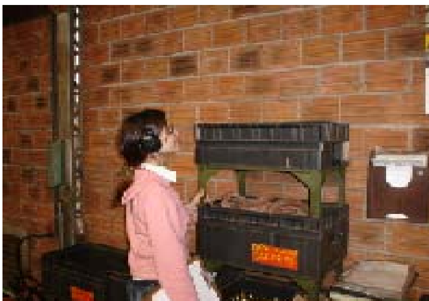
Figura 15: Caixa em local alto, dificultando acesso e visibilidade no setor Montagem de Eixo
