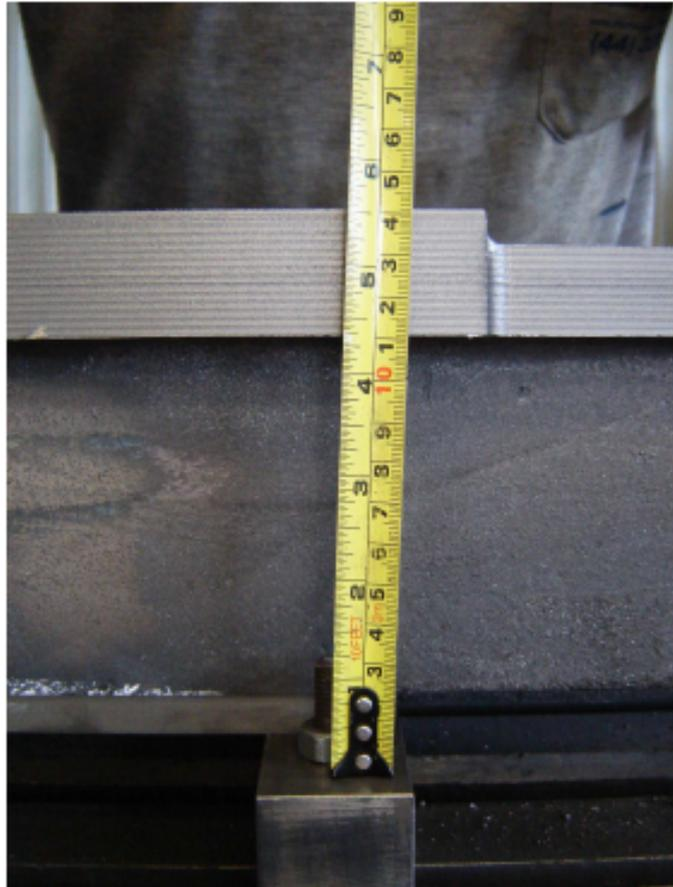
Foto A: Altura pré-usinada do barramento
