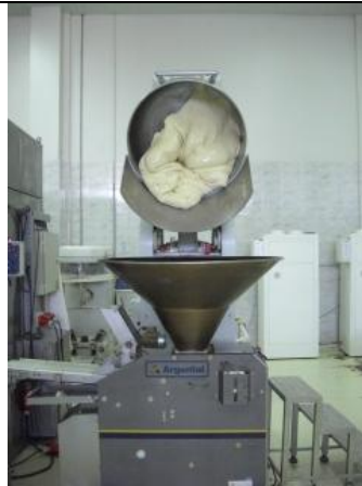
Figura 15: Processo de Elevação do Tacho da Amassadeira
