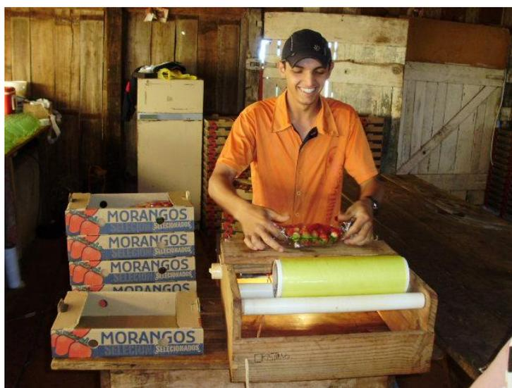
**Figura 9 - Funcionário plastificando a cumbuca de morango, na máquina de plastificação.**
