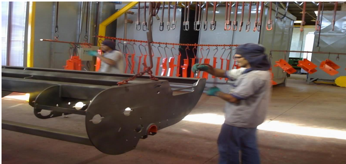
Figura 17: Retirada de partículas de granalha com uso da mangueira de ar comprimido.
