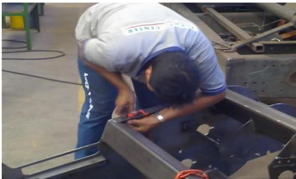
Figura 7: Fixação da corrente no chassi.
