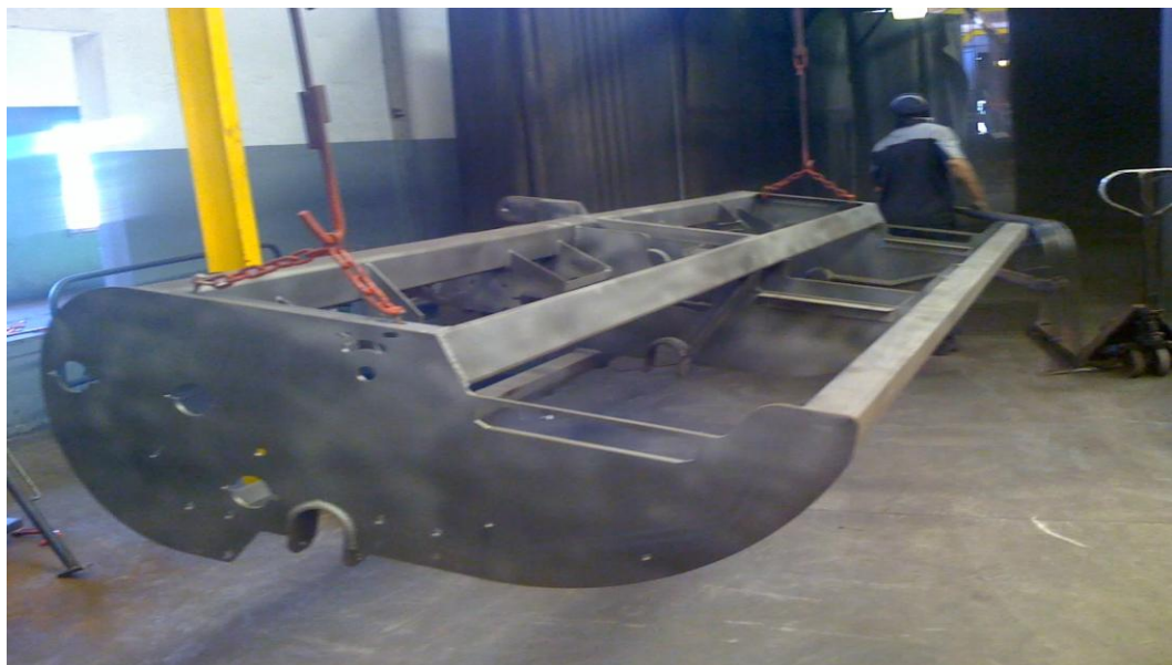
Figura 10: Chassi seguindo para cabine de jateamento.
