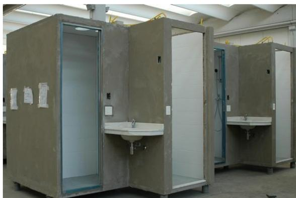
**Figura 2.5: Banheiro pré-fabricado em concreto armado - Fonte: [www.banheiropronto.com.br](http://www.banheiropronto.com.br).**
