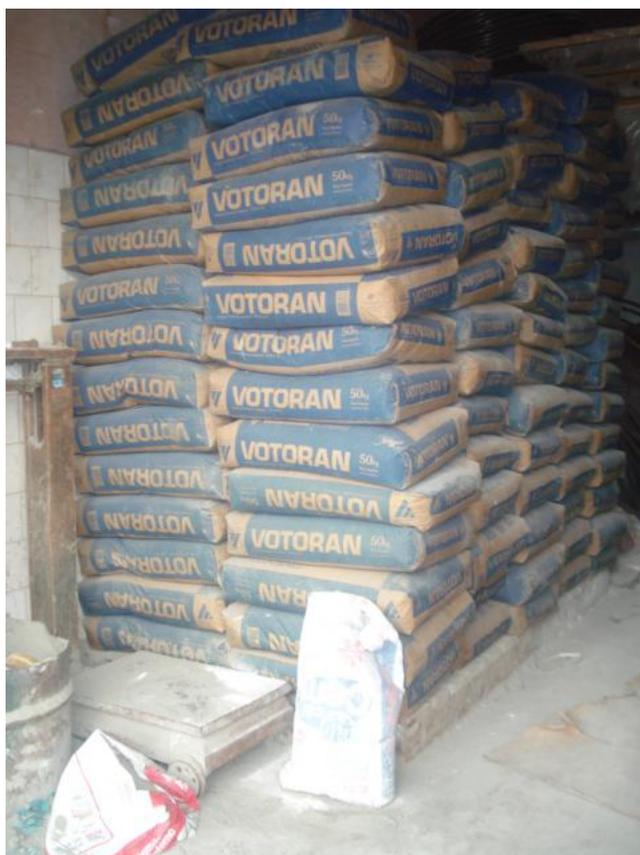
Figura 6.1: Estoque de cimento da empresa com uso de palete.
