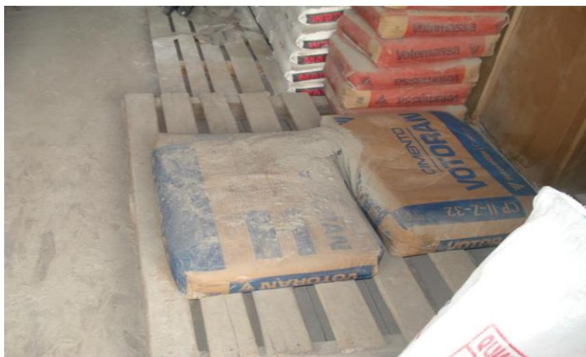
**Figura 6.3: Saco de cimento estourado no estoque.**
