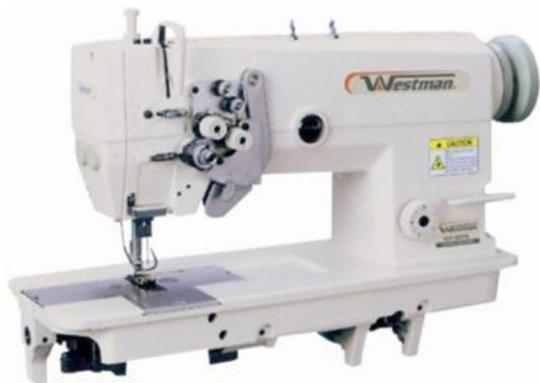
Figura 10: Foto da máquina reta duas agulhas, da marca Westman.
