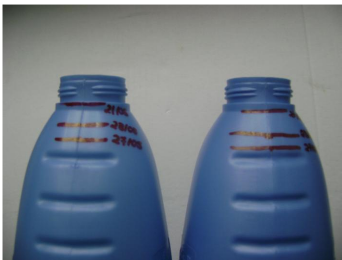
Figura 31 : Amaciante Tipo A envasado a 62 frascos/min e 82 frascos/min, respectivamente, após 6 dias
