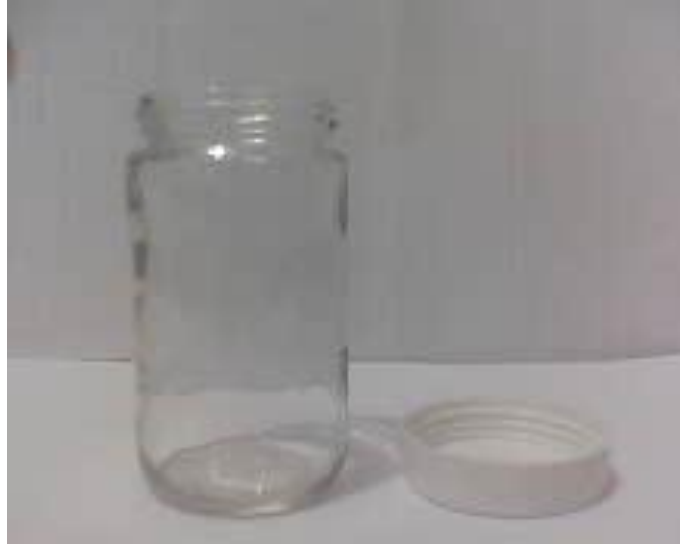
Figura 37 : Frascos padrão utilizado para determinação da densidade
