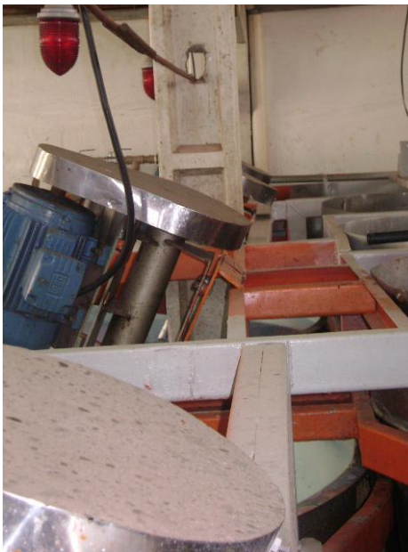
Figura 43 : Diferentes ângulos nos eixos das hélices (superior)
