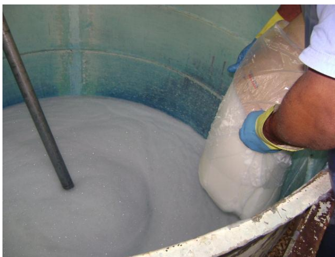
Figura 9: Adição da base no processo de fabricação do amaciante
