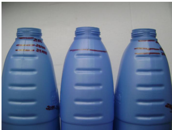
Figura 32 : Amaciante envasado a 62 frascos/min, padrão (2L) e 82 frascos/min, respectivamente
