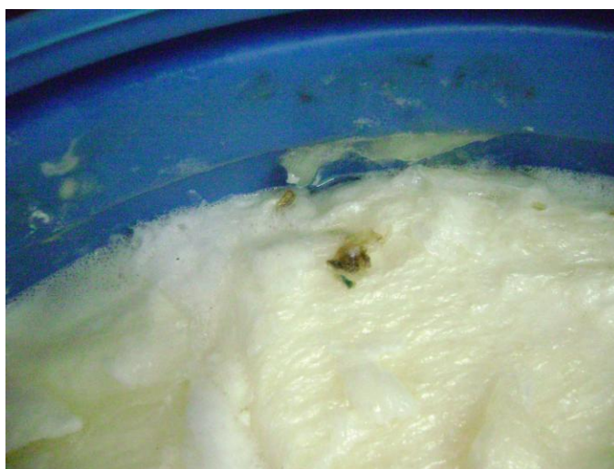
Figura 16 : Manchas nas bases utilizadas para fabricação do amaciante Tipo B
