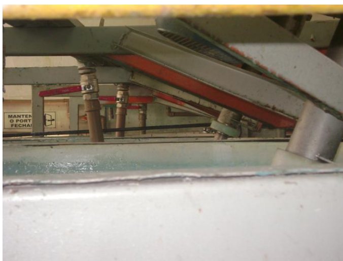
Figura 44 : Diferentes ângulos nos eixos das hélices
