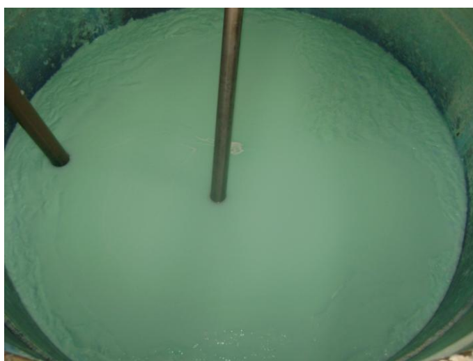
Figura 41: Superfície heterogênea do amaciante Tipo B durante o envase
