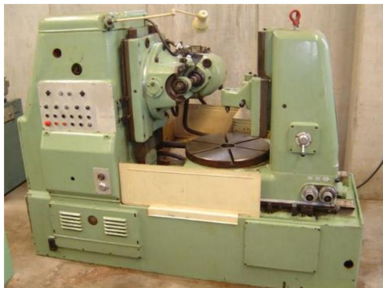
**Figura 9 - Geradora de dentes vertical (engrenagens)**
