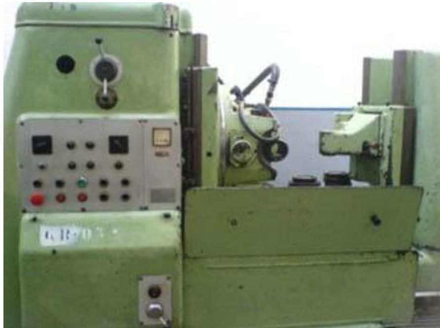
**Figura 8 - Geradora de dentes horizontal (eixos)**
