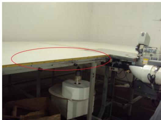
**Figura 36: Ajuste da medida do sensor da máquina Porter.**
