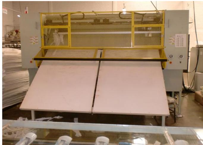
**Figura 13: Máquina de corte Gribetz.**
