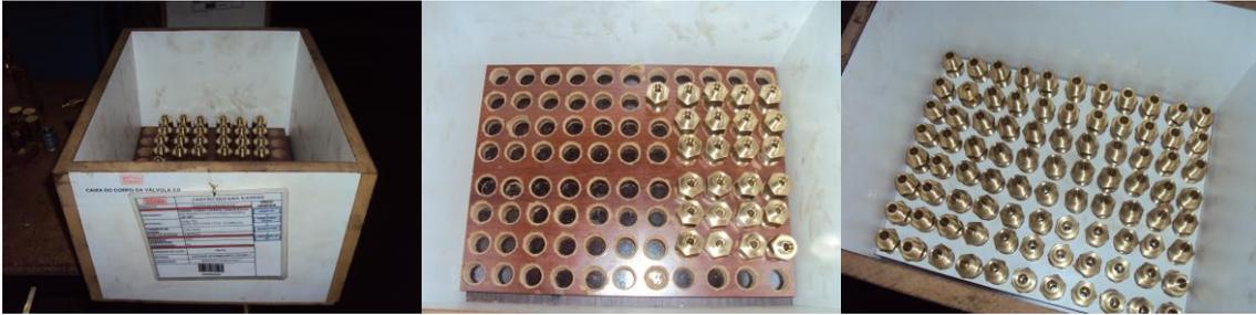
**Figura 10: Método Novo de Armazenamento do Componente Corpo**
