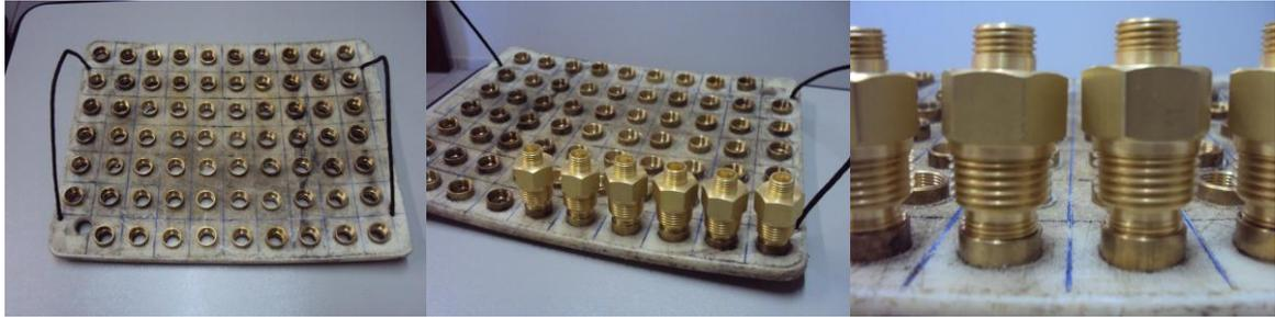
**Figura 11: Dispositivo de Armazenamento e Lavagem para o componente Corpo**
