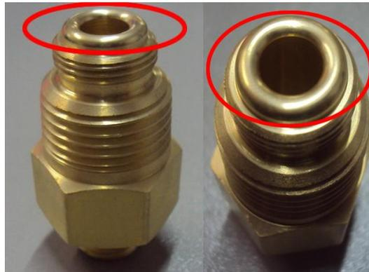
**Figura 4: Detalhe do raio de vedação do componente Corpo**
