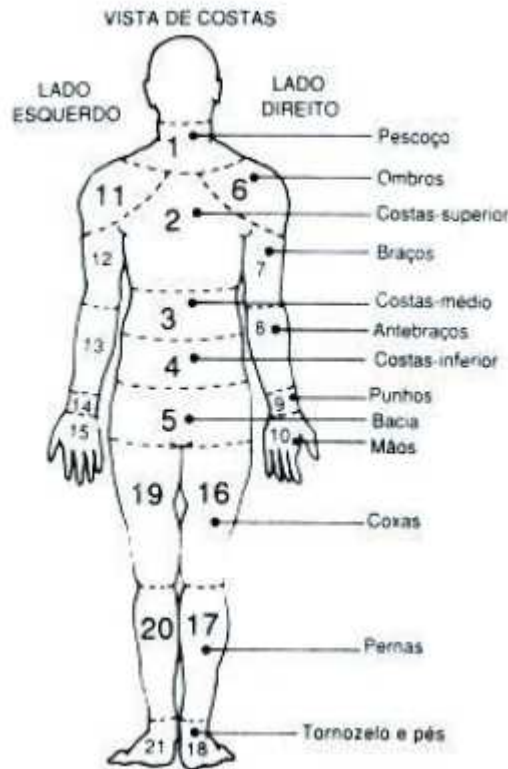
Figura 2: Diagrama para indicação das áreas dolorosas de Corlett e Manenica. Fonte: PINTO; XAVIER e COELHO, 2005.
