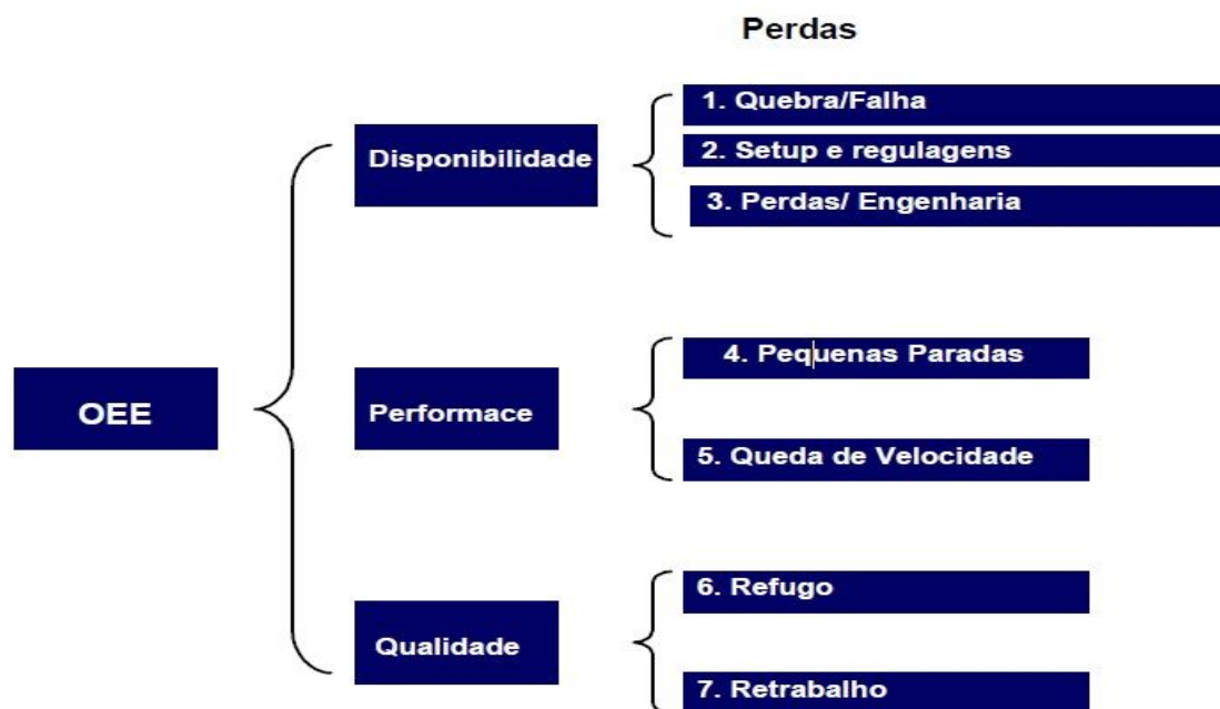
Figura 2 - Elementos da eficácia global de uma máquina
