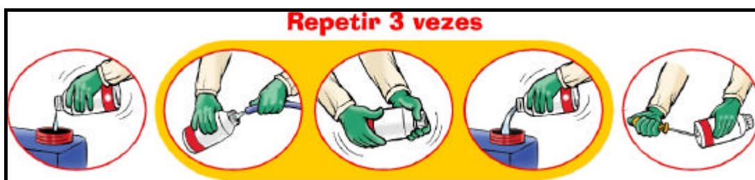
Figura 10: Procedimento de lavagem sob pressão Fonte: Andef (2005)
