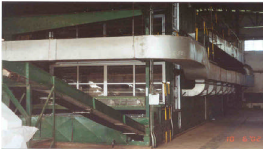
Figura 3: Secador de Casulos Fonte Cocamar
