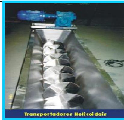
Figura 25: Transportador helicoidal
