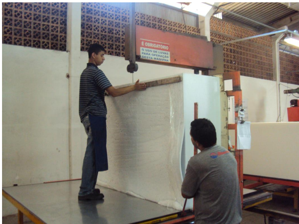
Figura 50 - Estabilização do toco para corte.
