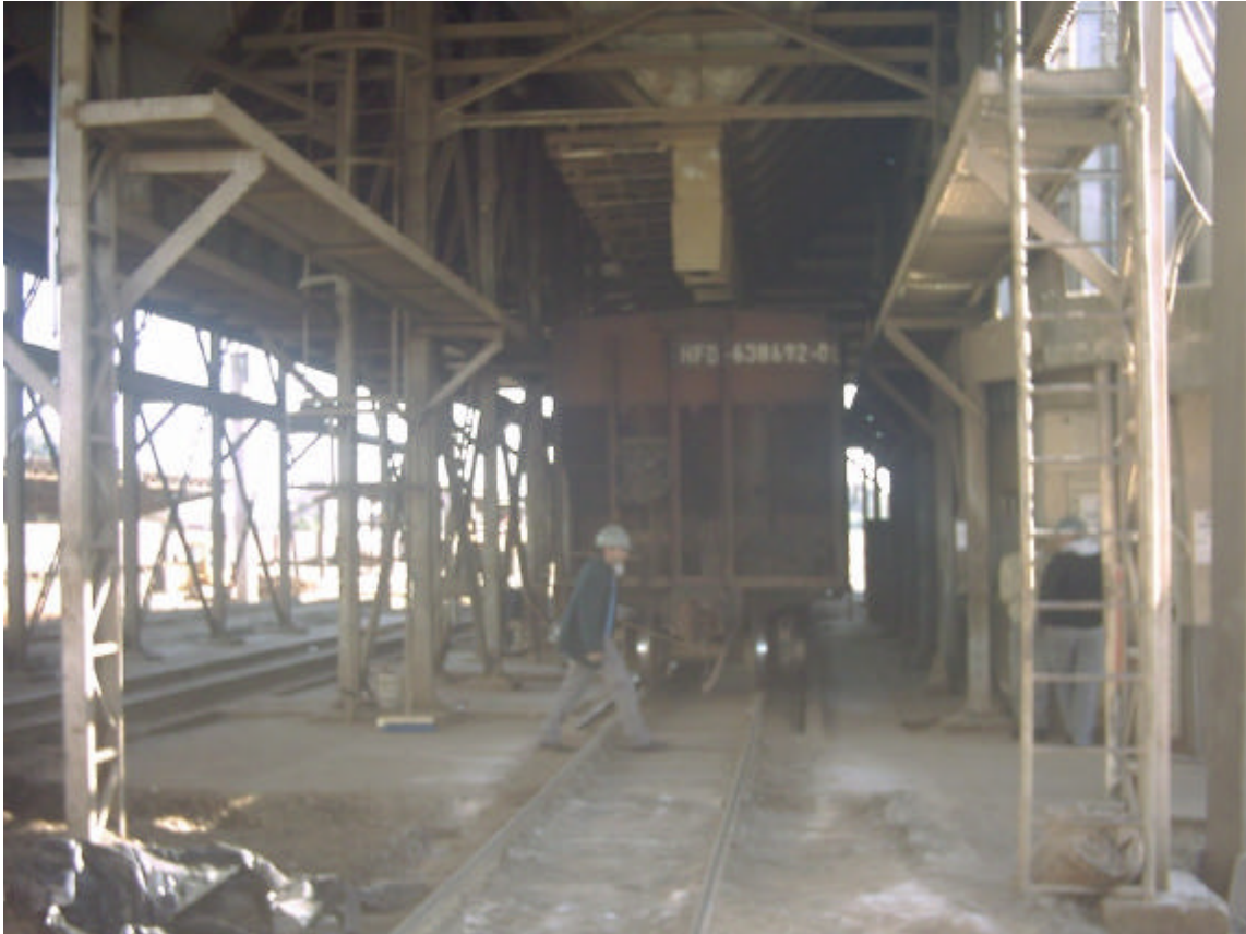
Figura 9: Encoste do vagão na balança ferroviária para pesagem e carregamento.
