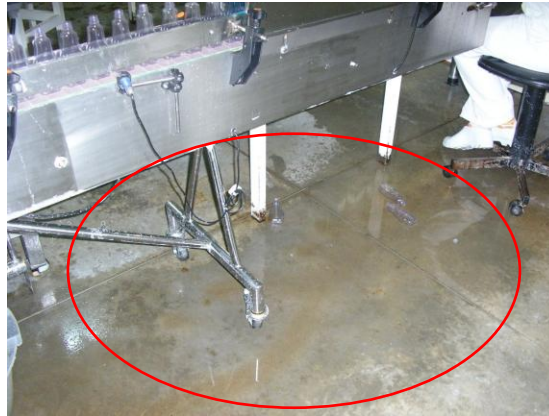
Figura 24 – Visão do chão do setor quando há vazamento
