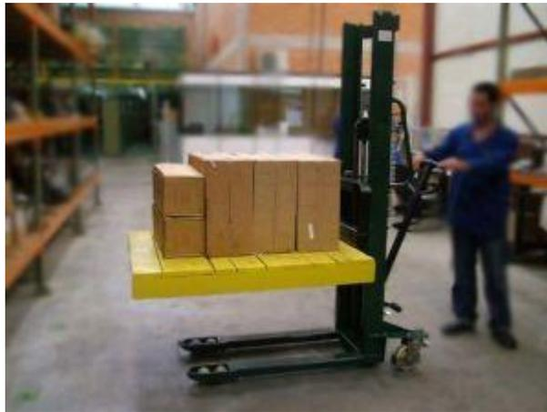
**Figura 16 - Exemplo de empilhadeira manual hidráulica**
