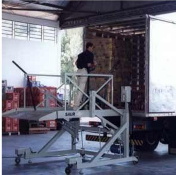
**Figura 19 - Modelo de Plataforma Hidráulica Elevatória Móvel**
