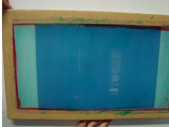
Figura 5 - Tela utilizada no processo de serigrafia
