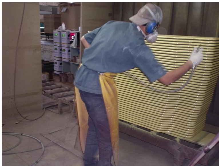
Figura 4.8: Setor de pintura da borda das peças
