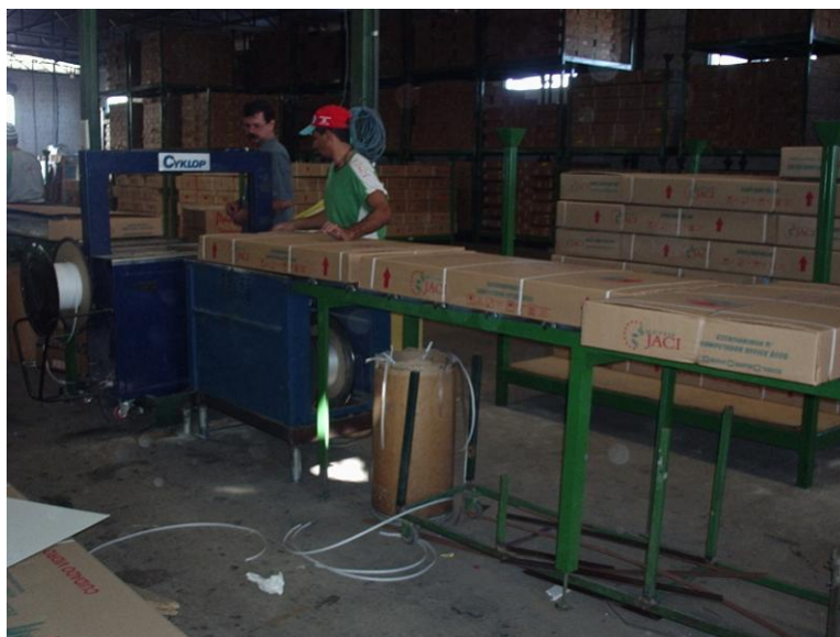
Figura 4.12 : Momento em que as caixas são fechadas com a fita de arquear
