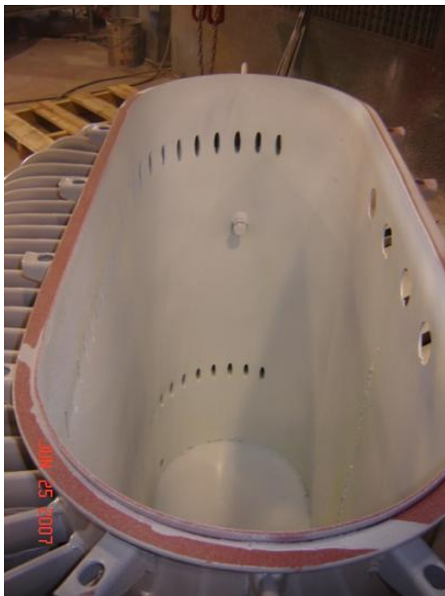
Figura 20: Pintura interna do tanque.
