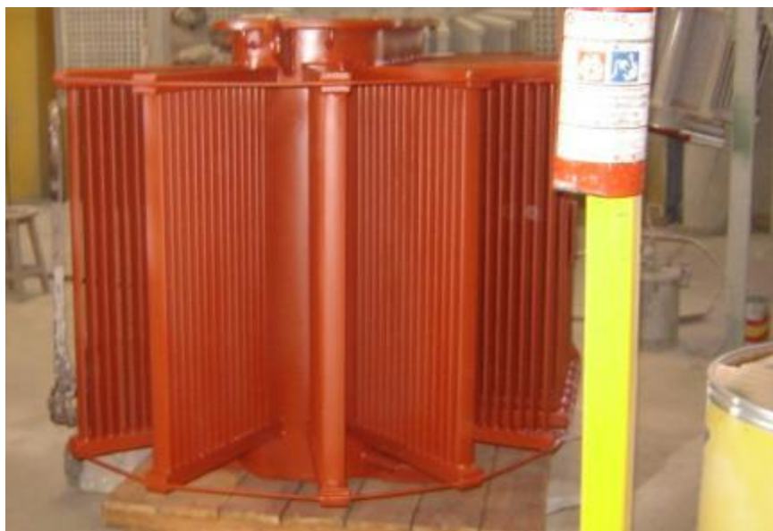
Figura 18: Tanque com a etapa de Primer executada.
