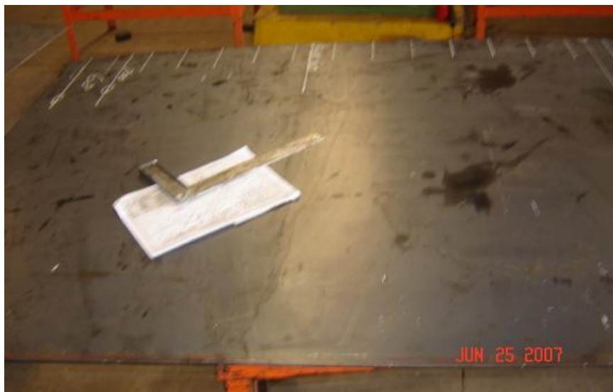
Figura 12: Riscamento da chapa.
