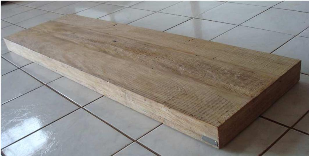
**Figura 14 - Bancada de Tábuas devolvida por defeitos na superfície**
