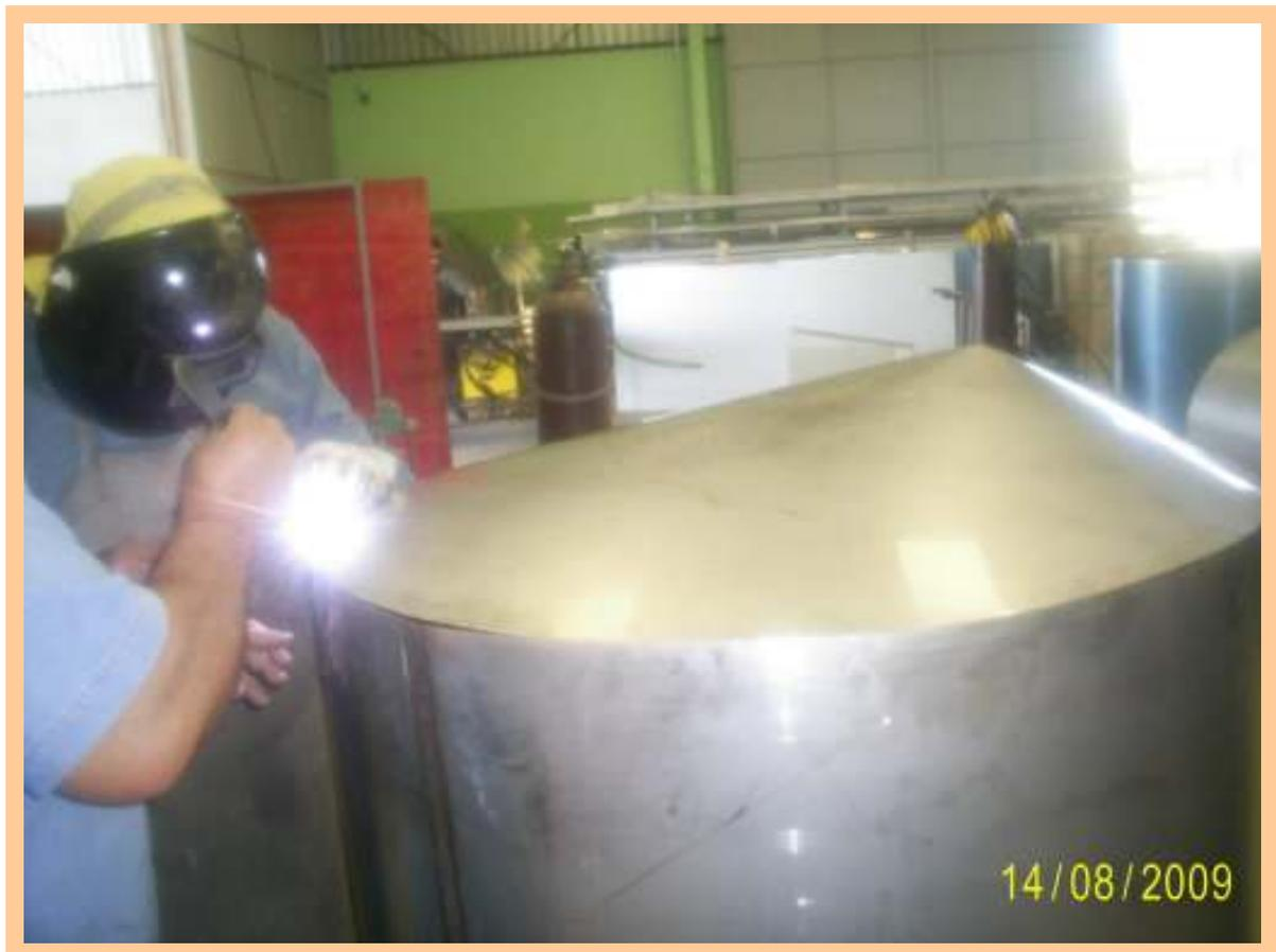
Figura 24 - Solda do fundo do tanque interno.
