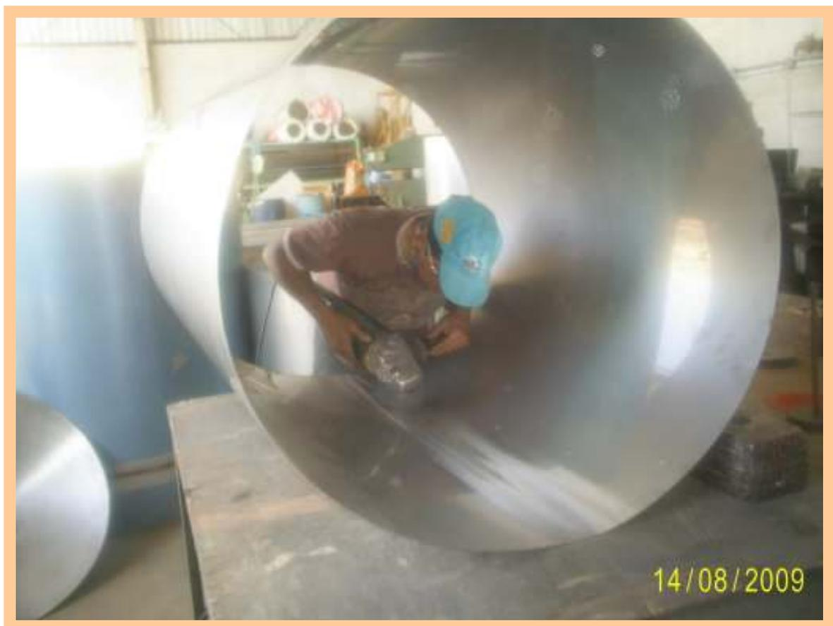
**Figura 34 - Acabamento da solda no corpo interno.**
