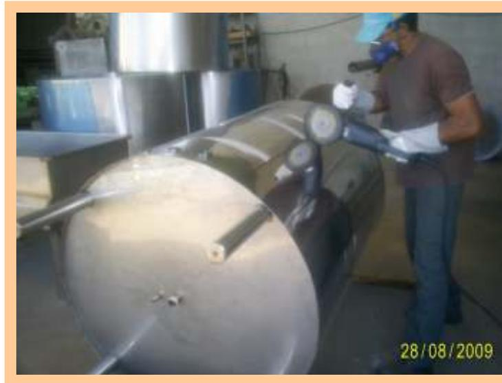
**Figura 38 - Espelhamento da blindagem do isolamento.**
