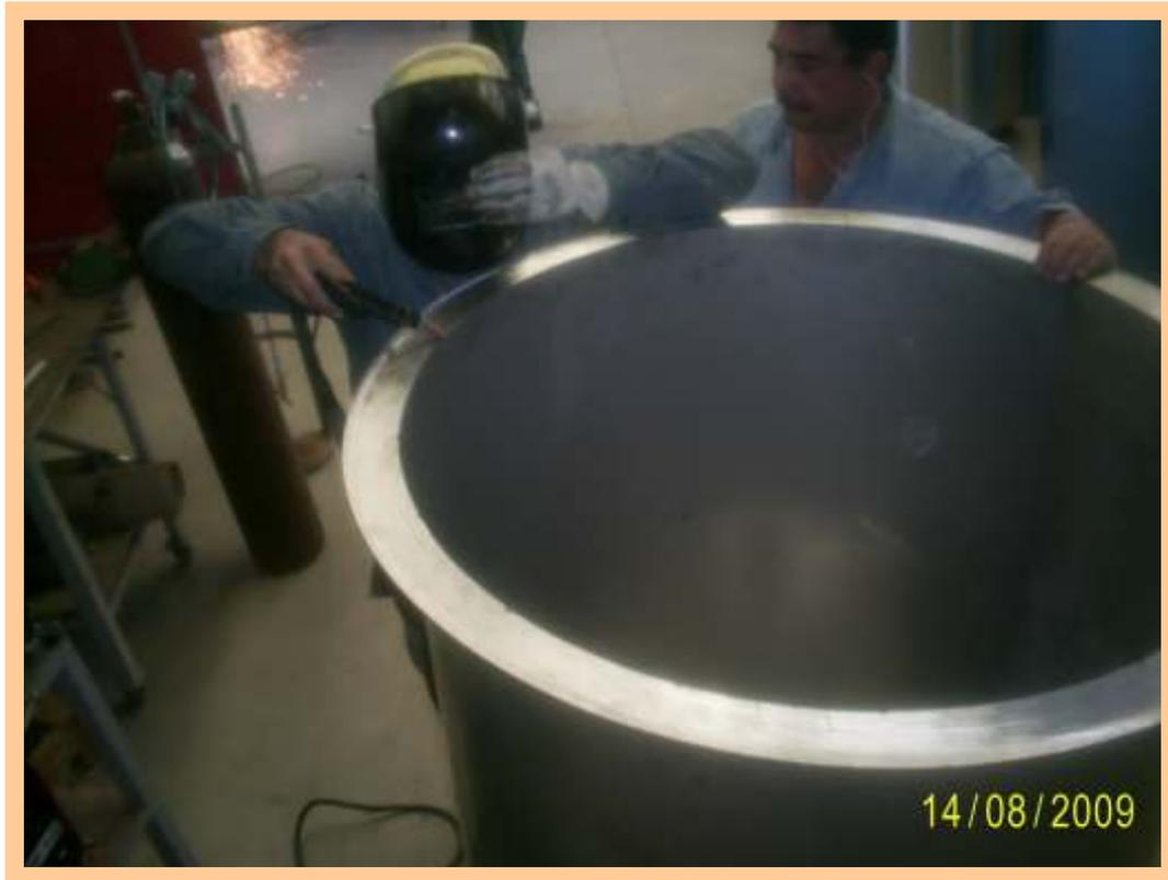
**Figura 25 - Solda do Anel superior no corpo interno.**
