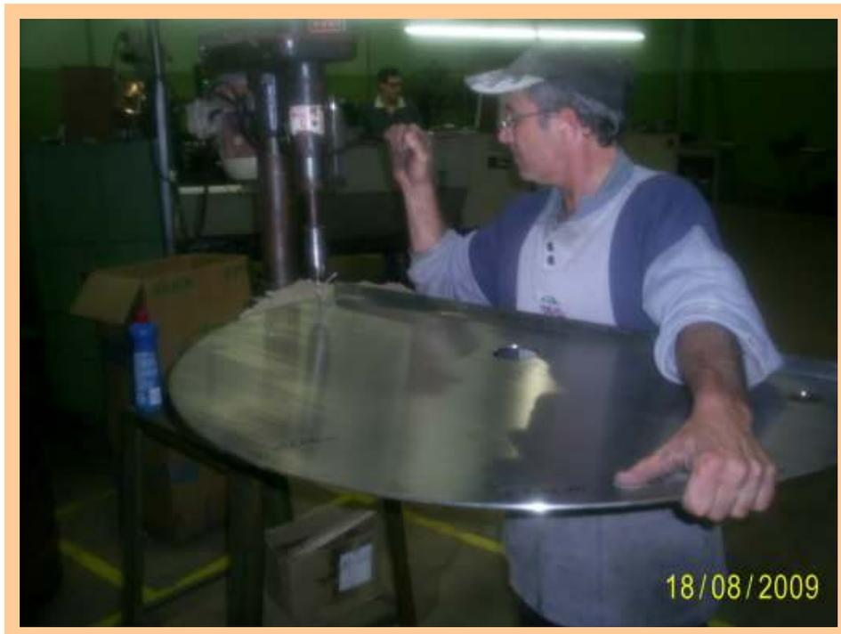
**Figura 47 - Executando furação na tampa fixa Ilustração.**
