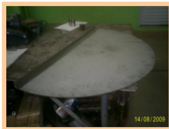
**Figura 15 - Corte dobra da tampa fixa.**
