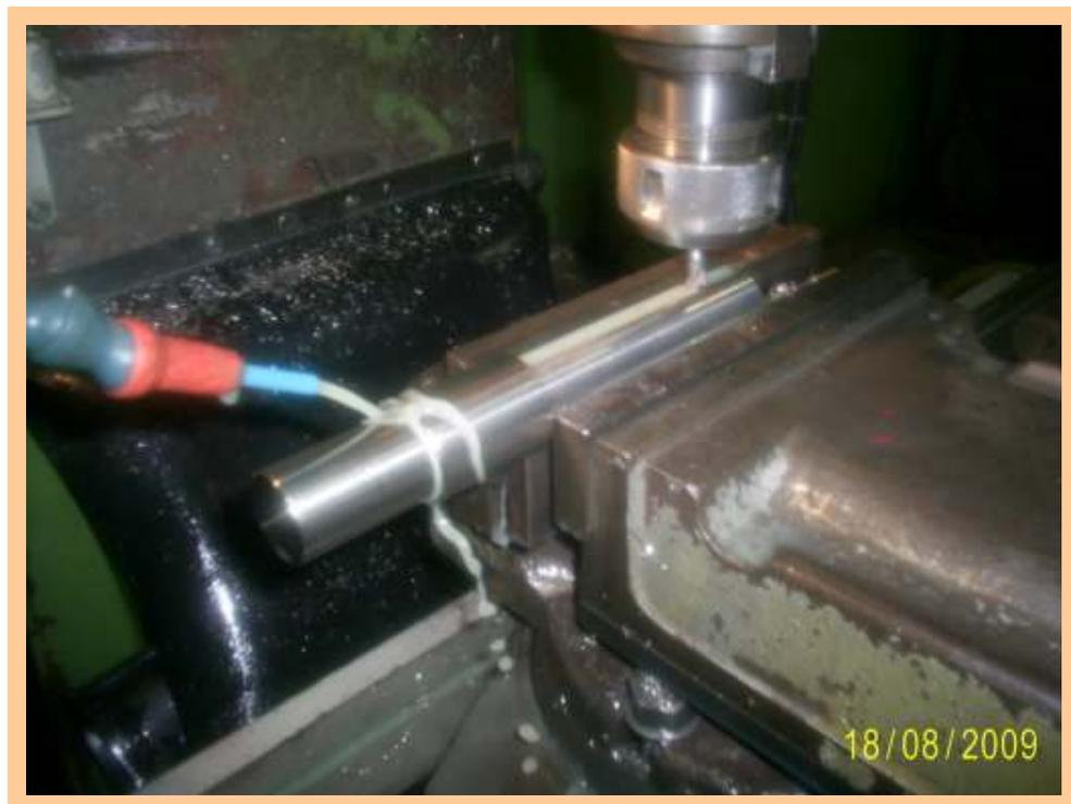
**Figura 42 - Executando rasgo de chaveta no eixo do acionamento.**
