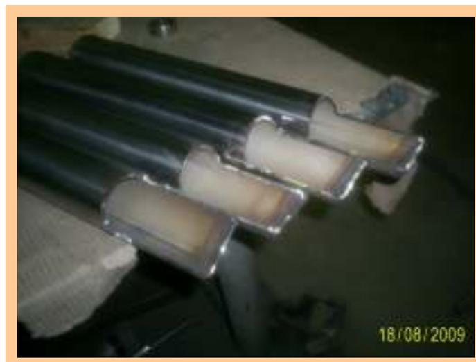
**Figura 18 - Recorte dos pés para soldar no tanque externo.**
