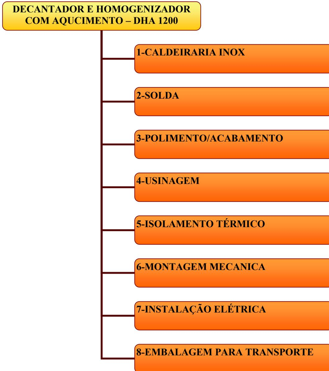
Figura 2 – Fluxograma de operações de fabricação.
