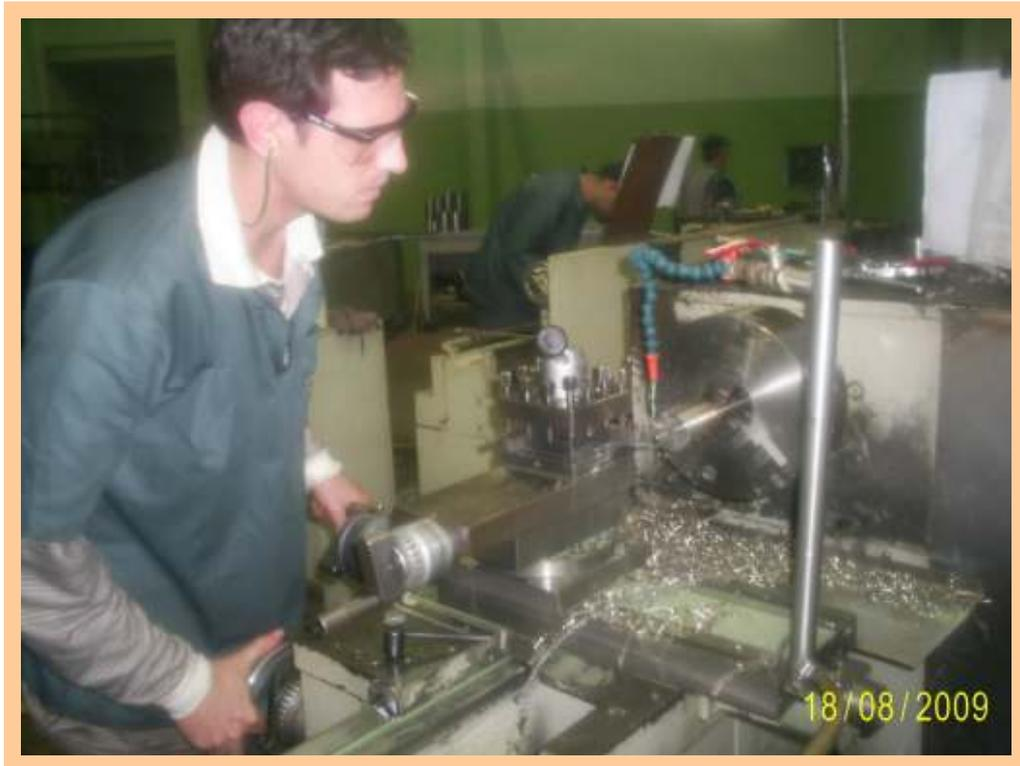
**Figura 41 - Torneando eixo do acionamento.**
