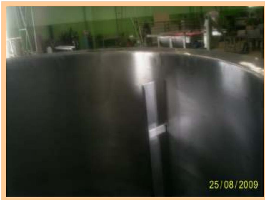
**Figura 23 - Quebra vórtice montado.**
