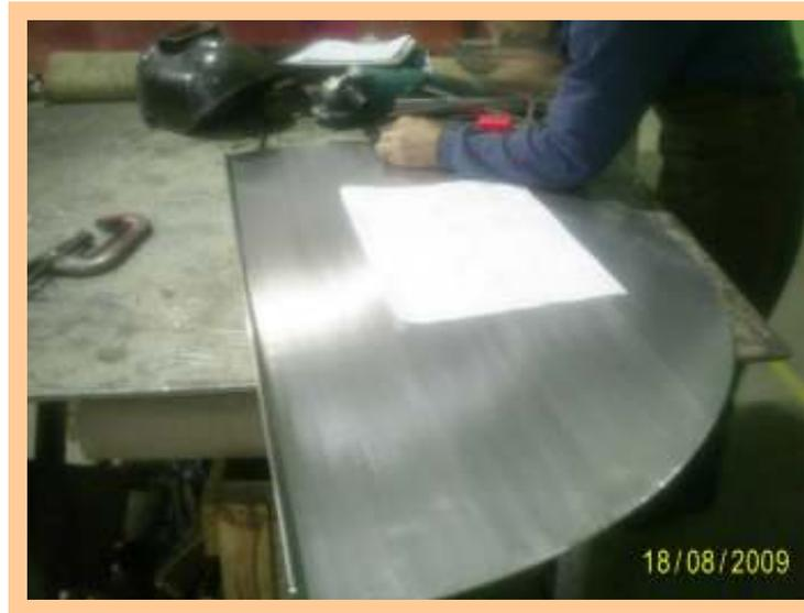
**Figura 16 - Marcação da furação na tampa fixa.**
