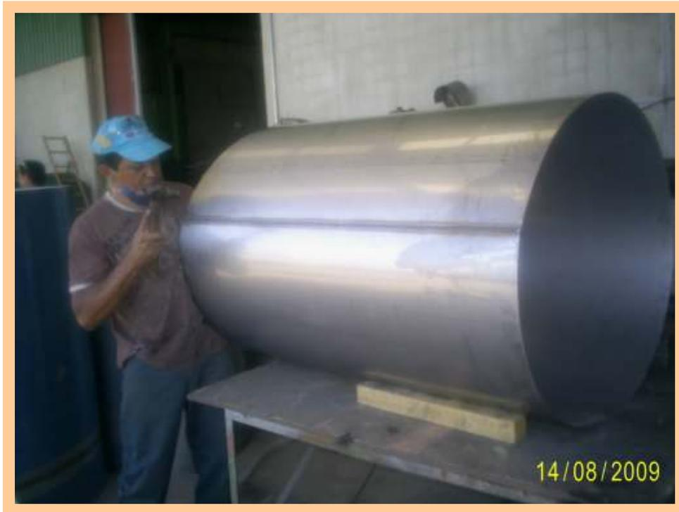
**Figura 33 - Rebatimento da solda do corpo interno.**
