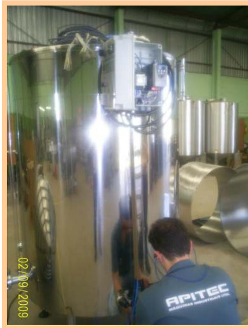
**Figura 63 - Montagem Painel e resistência elétrica no equipamento.**
