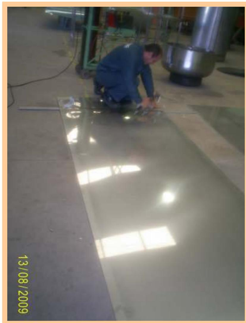
Figura 3 – Corte e Planificação de chapas.
