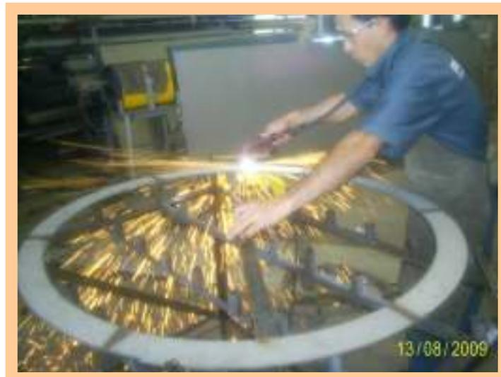
**Figura 9 - Refilamento do anel superior.**
