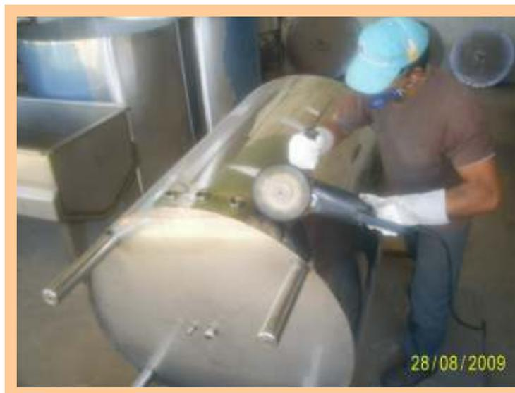
**Figura 39 - Espelhamento da blindagem do isolamento.**
