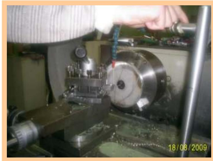
**Figura 43 - Torneando disco de fixação do Acionamento.**
