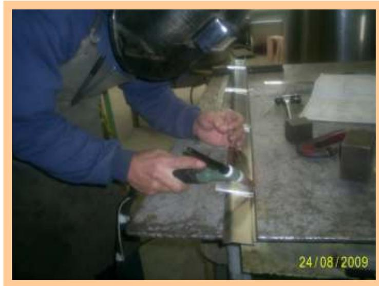
**Figura 31 - Solda de pré-montagem do quebra vórtice.**
