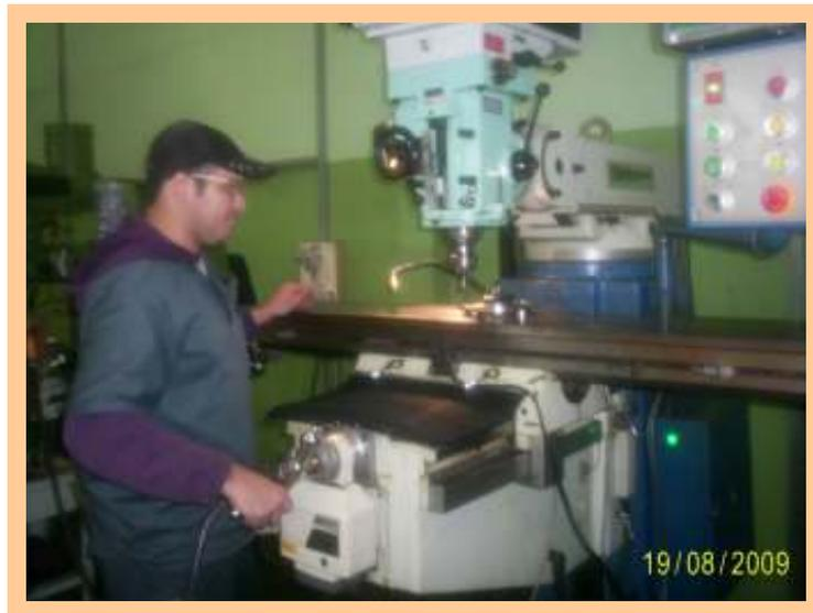
**Figura 44 - Preparação para executar furação em disco torneado.**
