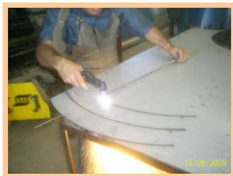
**Figura 7 – Corte anel superior.**
