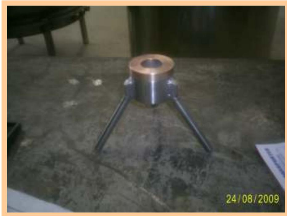
**Figura 46 - Mancal de apoio do eixo mexedor usinado e com mancal montado.**
