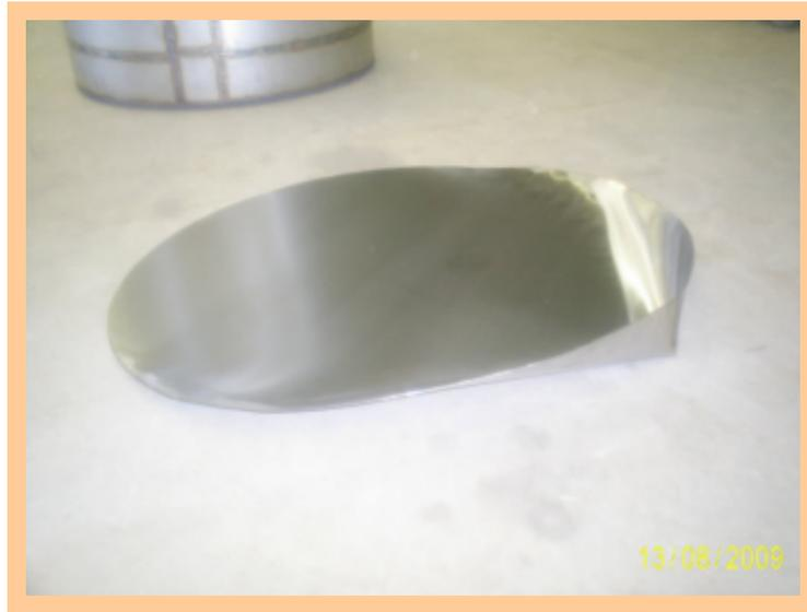
**Figura 4 – Fundo do tanque interno.**
