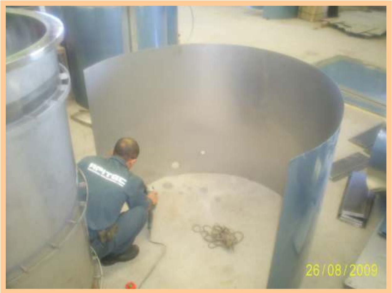
**Figura 49 - Preparação da blindagem externa para revestir com lã de rocha.**
