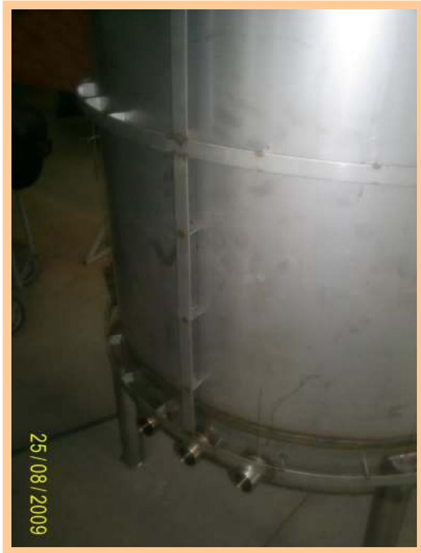
**Figura 51 - Colocação dos anéis de fixação da lã de rocha.**
