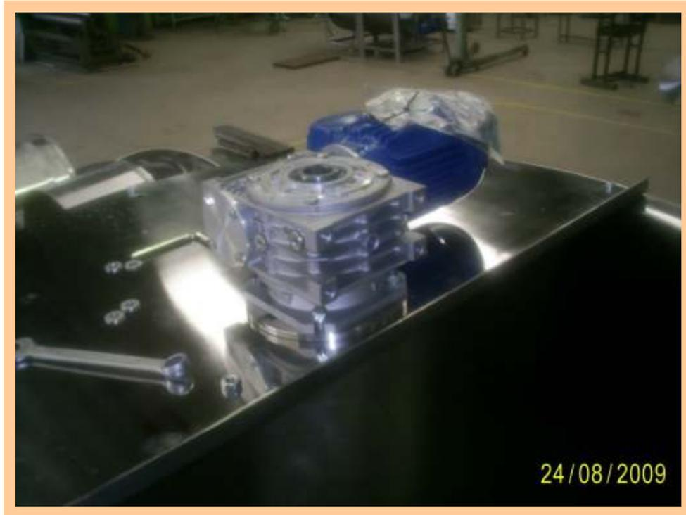
**Figura 57 - Montagem final do acionamento.**
