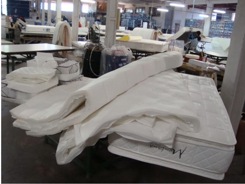
Figura 21: Tampos defeituosos rejeitados no momento da montagem.
