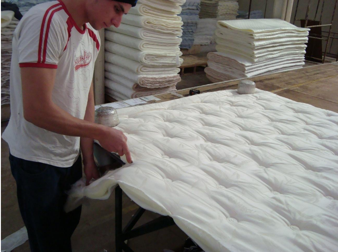
Figura 23: Operação de concerto dos tampos com defeitos.
