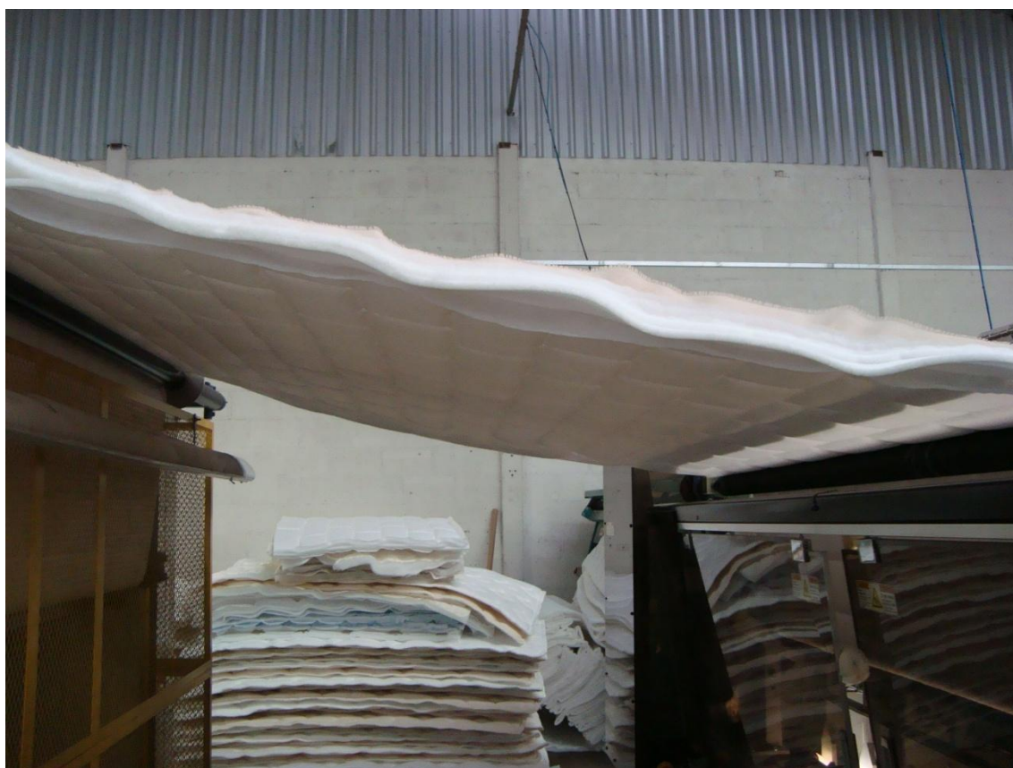
Figura 7: Material matelassado entre a bordadeira e a máquina de corte.
