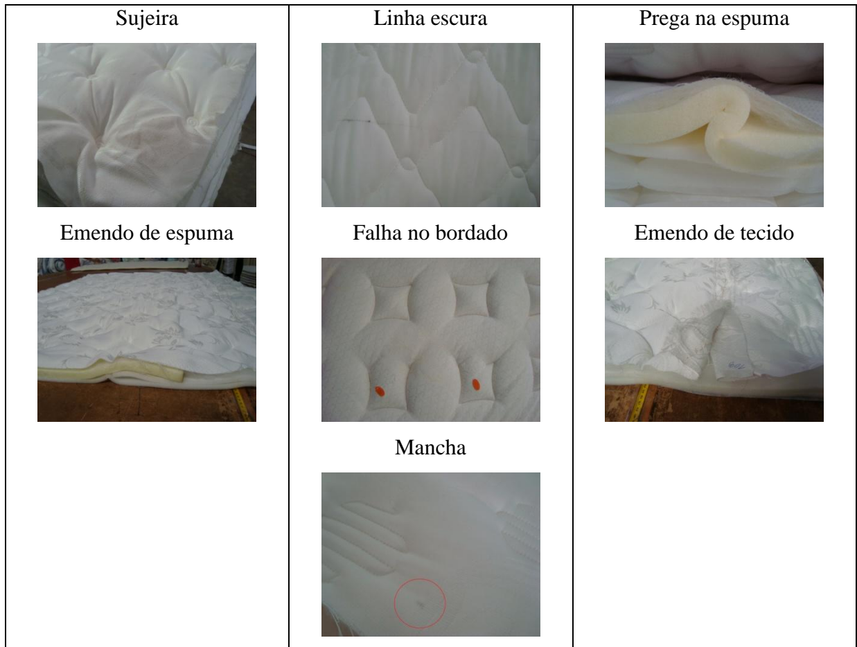
Figura 29: Tipos de defeitos encontrados nos tampos.
