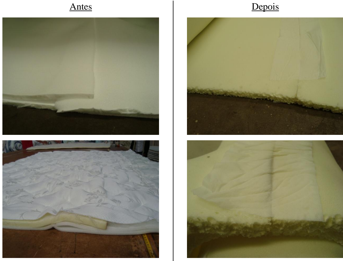
Figura 35: Métodos para junção das lâminas de espuma.
