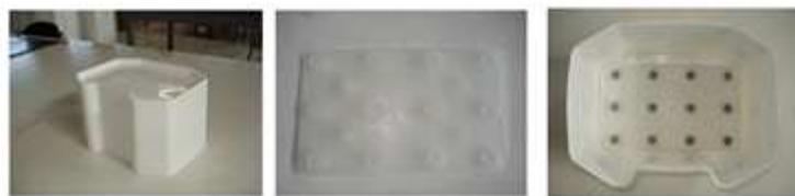
**Figura 8 - Componentes injetados X prontos (da esquerda pra direita: Base Vida Branca Injetada, Chapinha Injetada e Base Vida Branca Pronta com chapinha de ímãs)**
