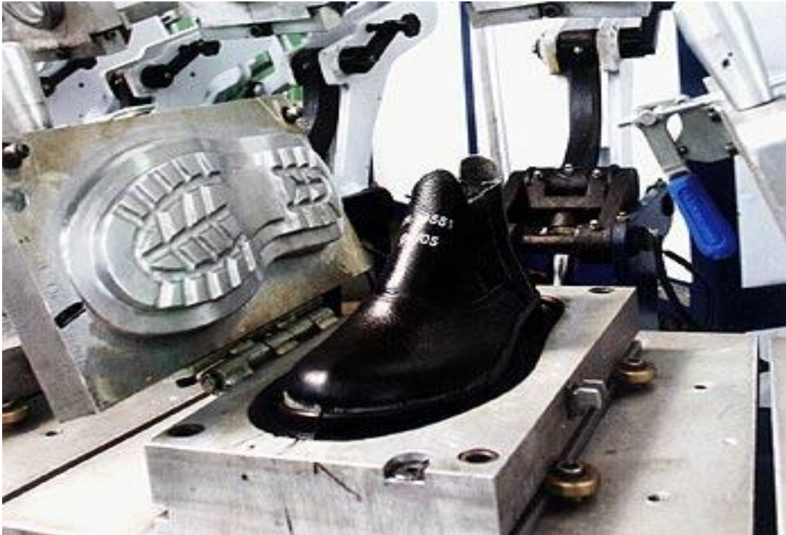
Figura 2: Estação de Injeção
