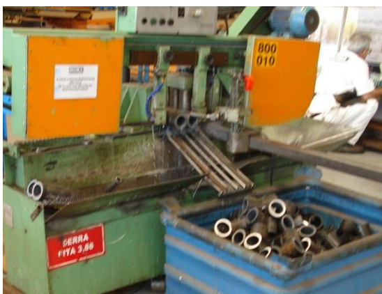
Figura 8 – Máquina de corte – Serra-Fita – antes e depois da melhoria
