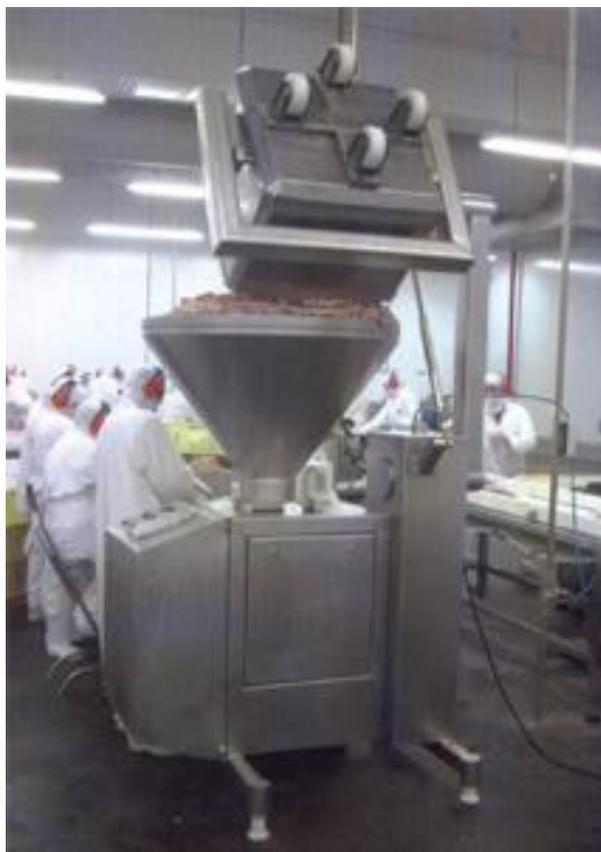
**Figura 7: Modelo de embutideira utilizada pela empresa**
