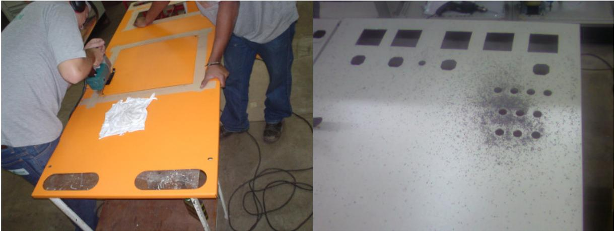
**Figura 19: Porta e chapa de montagem do painel sendo cortados.**
