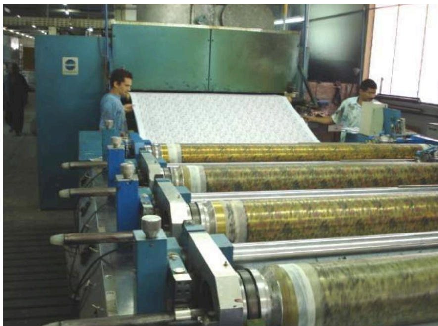
Figura 2 - Estamparia por cilindros
