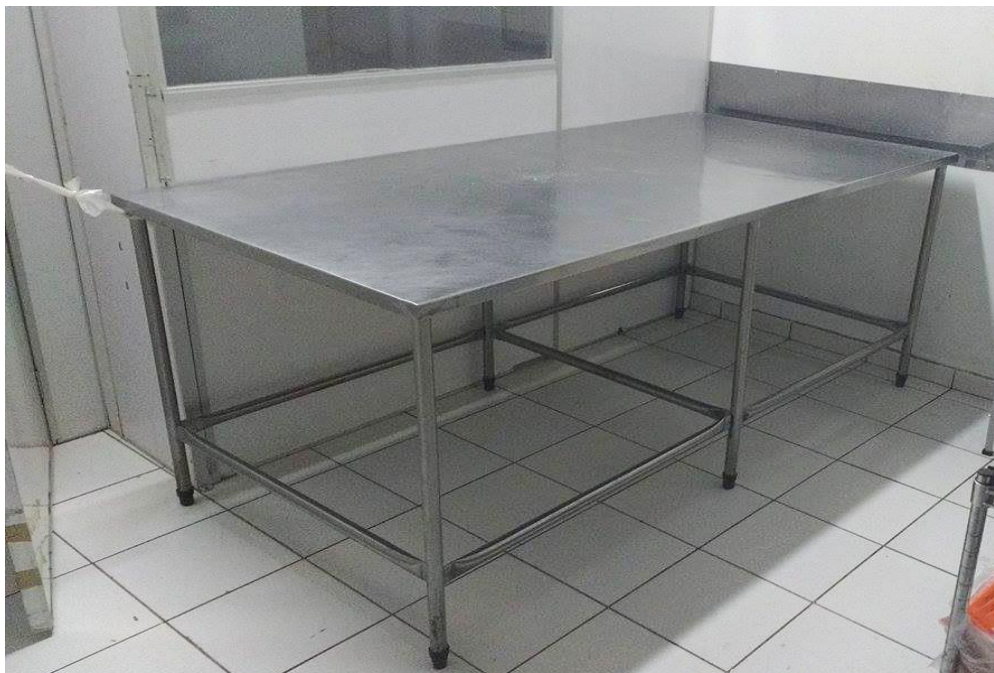
Figura 19. Bancada com tampo de aço inox.
