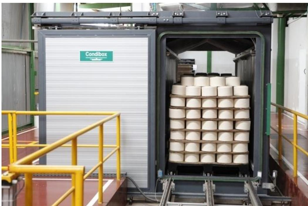
Figura 18: Processo de vaporização dos fios.
