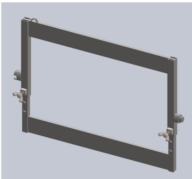
A tela proposta (Figura 19) é confeccionada com tubos retangulares de aço carbono ou aço inox 2 ¼”, com módulo de resistência à flexão de 2731,17 mm<sup>3</sup> (7,8 vezes maior que a tela anterior). A fixação das partes diminui o tempo de *setup*, devido à fácil fixação com parafuso borboleta, diferente do anterior, e a geometria do novo material diminui as perdas no processo seguinte de “corte na guilhotina 1”.
