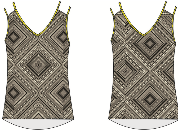
Figura 11 - Exemplo de peça cortada com rapport e sem rapport
