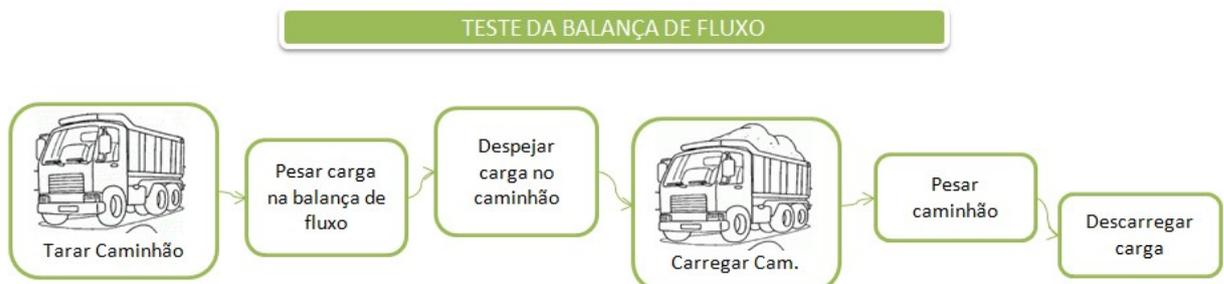
Figura 9 - Teste balança de fluxo
