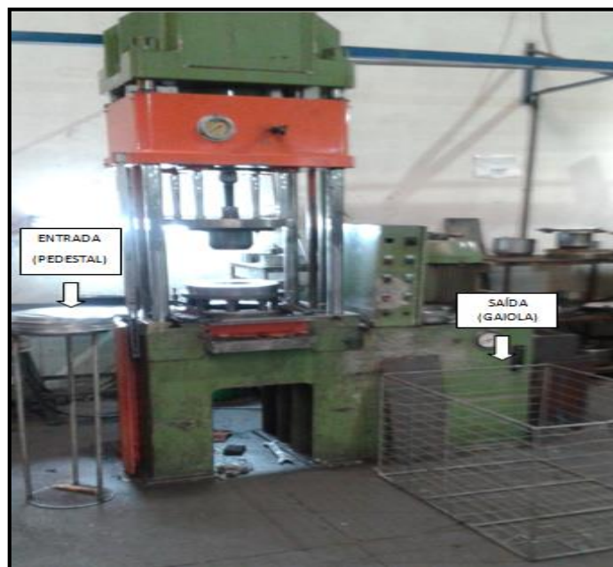
Figura 21: Posicionamento dos discos de alumínio e da gaiola.
