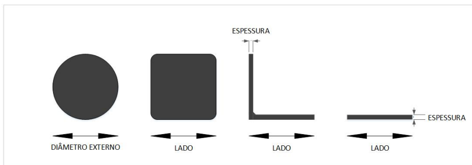
Figura 3.7 - Barras mecânicas laminadas redonda, quadrada, cantoneira e chata
