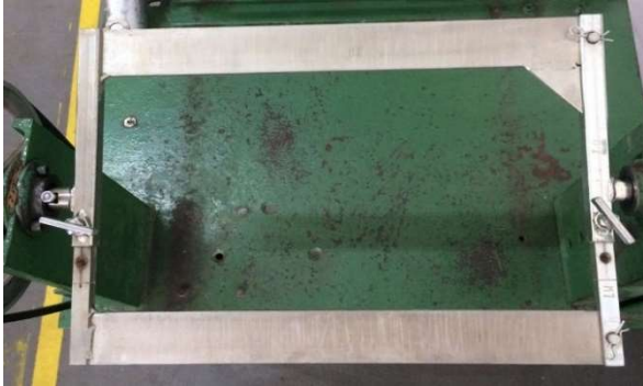
Figura 5 – Exemplo de tela utilizada no processo de tratamento térmico de PET
