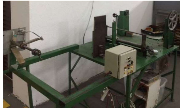
Figura 6 – Máquina referente a atividade de alimentação de telas com fio de PET
