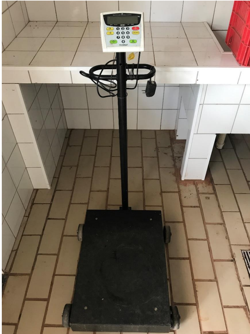
Figura 2 – Balança da marca Filizola usada para pesagem dos resíduos
