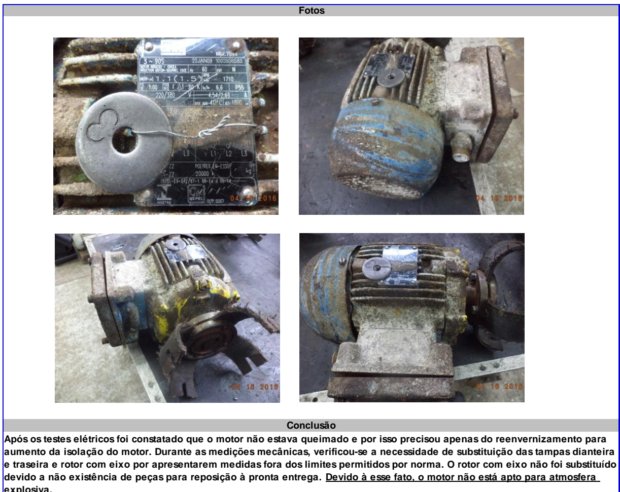
Figura 5: Relatório de fotos previamente à desmontagem do motor e a conclusão.
