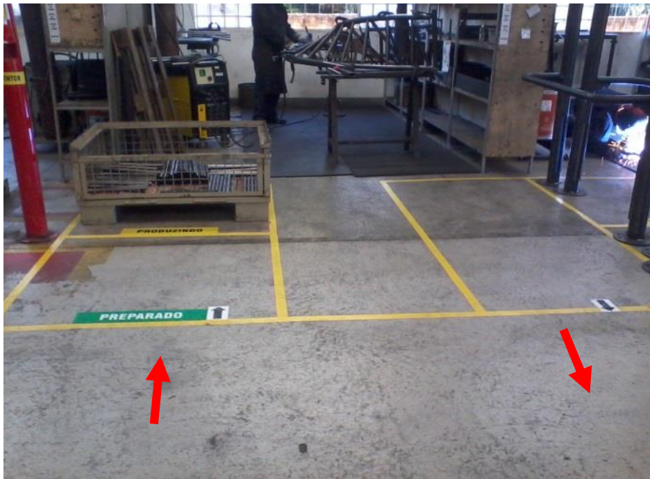
Figura 13- Marcações da situação dos kits no box de solda
