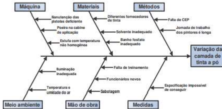
Figura 2 – Exemplo de diagrama de causa e efeito
