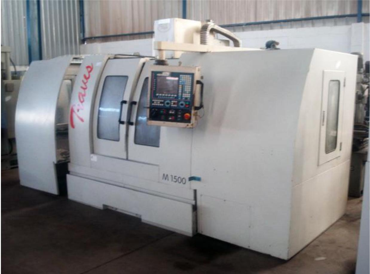
Figura 5: Centro de Usinagem TRAVIS M 1500
