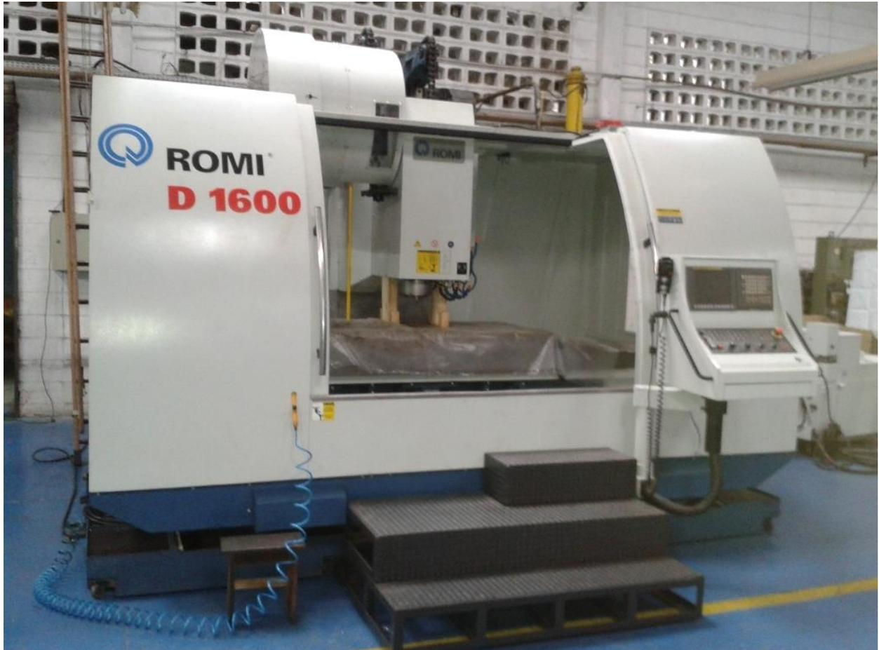
Figura 7: Centro de Usinagem Vertical Romi D1600
