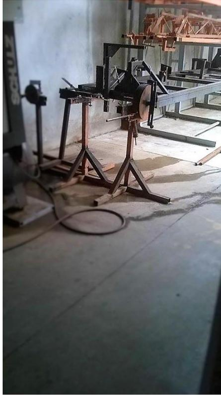
**Figura 18 - Cavalete giratório de engate rápido**
