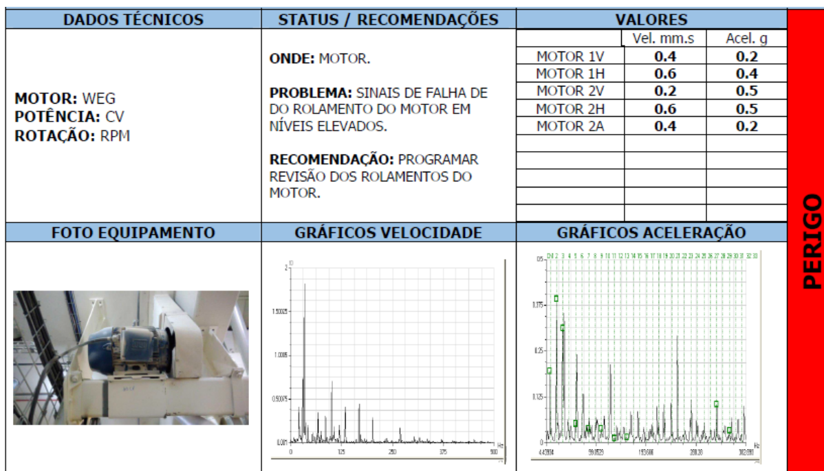
Figura 19 – Análise de vibração realizada no equipamento de tag MG1MOT0003 (Banco de Cilindros).
