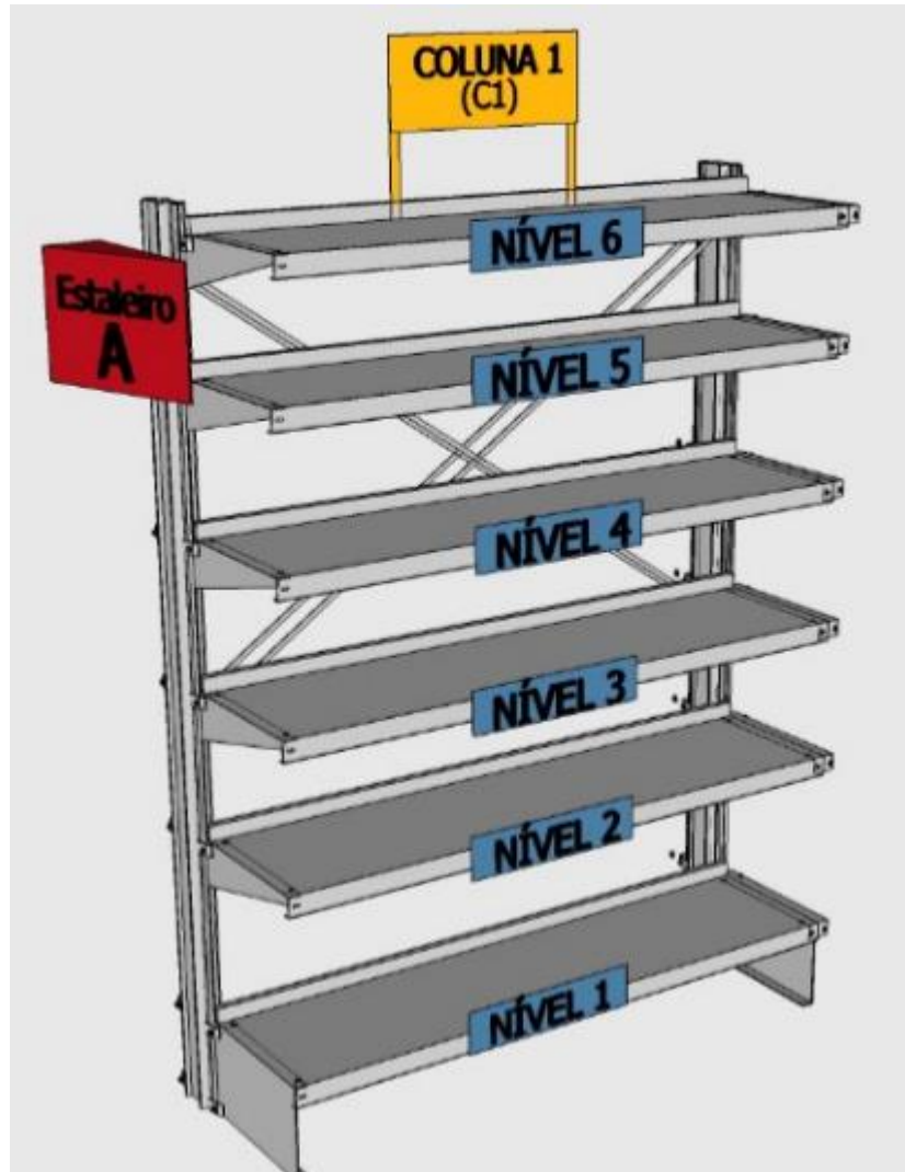
Figura 10 – Estaleiro 3D do novo sistema de endereços.
