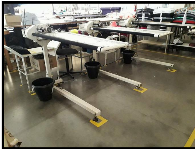
Figura 12 - Demarcação com fita no Debrum
